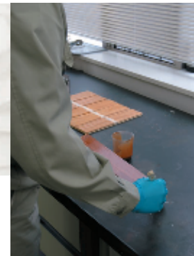
スギの板材に木材保護塗料「キシラデコール」を試し塗り、同じ色の塗料でも製造時期によって色の出方に差が生じかねないので、それが最小限の範囲に収まるように実際に木材に塗って確かめる
