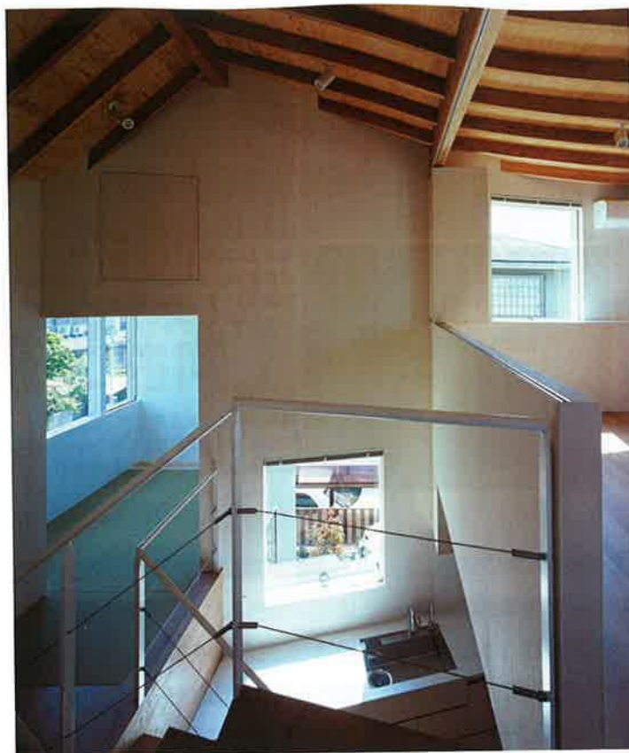
奈良市内に4月に完成した木造住宅。「明るく、温かみのある家にしたい」との要望を受け、内装は質感のある白でまとめた。写真左は、2階寝室から1階キッチンを見下ろし。写真右は、1階リビングから半地下や中2階に通じる階段を見たところ。壁面はいずれもシナ合板で、ここをキシラデコールインテリアファインで仕上げた (建築写真/鈴木 研一)
