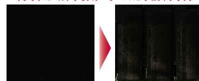
初期板 試験後(5年相当) ※1 促進耐候性試験の結果となり、実現場の劣化とは異なります。
