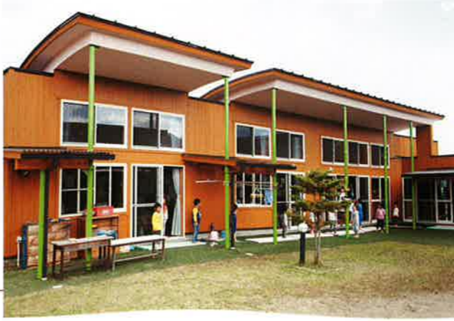
花巻市立成島保育園。昨年10月、木製の外壁と金属製の屋根を塗り替えた。外壁の塗り替えに用いたのは、キシラデコールコンゾランの「ビニー」。写真右上のように、木質感が損なわれないのが、特徴の一つだ
